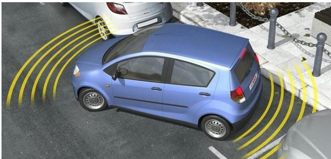
Abbildung 2: Ultraschallwellen bei einem Auto<sup>2</sup>
