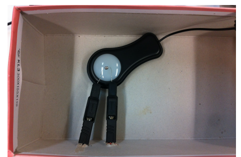
Abb. 4: Versuchsaufbau zur Lichtintensitätsmessung [eigene Aufnahme]
