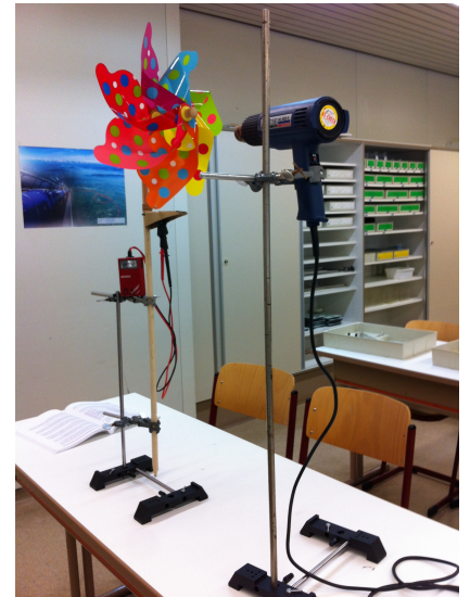
Abb. 3: Versuchsaufbau zur Messung der Windgeschwindigkeit [eigene Aufnahme]
